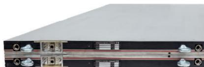
**Нагревательные плиты пресса HS** имеют сэндвичную конструкцию. Они состоят из охлаждающего профиля, нагревательной пленки и слоя теплоизоляции. Их отличают малый вес и гибкость, чем обеспечивается оптимальное распределение температуры.
