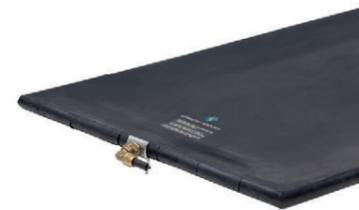
Прочная **нажимная подушка** с арамидным армированием предназначена для создания давления на стык. Подушка может заполняться воздухом или водой. Максимальное поверхностное давление: 140 Н/см<sup>2</sup> (14 бар).
