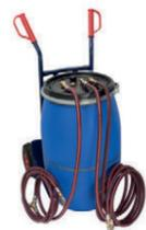
**Система водяного охлаждения** состоит из водяного бака на колесах емкостью 120 л, погружного насоса и комплекта шлангов. Она позволяет в кратчайшее время охладить нагревательные плиты.
