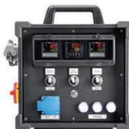
**Типы: AC2x16A / AC2x32A.** Пульт автоматического управления для 2 нагревательных плит. Индикация температуры на цифровом дисплее, регулирование с помощью регулятора PID.
